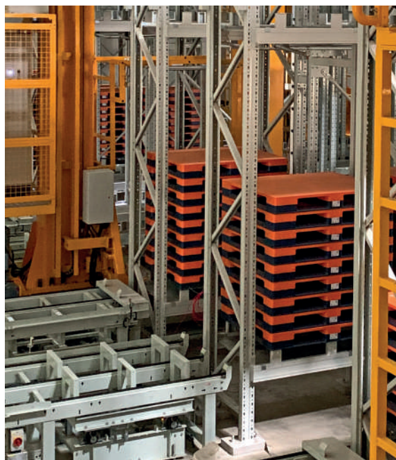
Czytnik TN-Q175 RFID stosuje się w miejscach jednoczesnego odczytu nawet dziewięciu ułożonych w stos pustych palet
