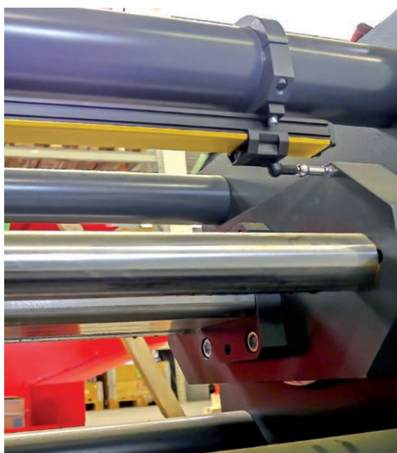
Czujnik jest odporny na wibracje i wstrząsy do 200g zapewniając przy tym precyzyjne wartości pomiarowe
