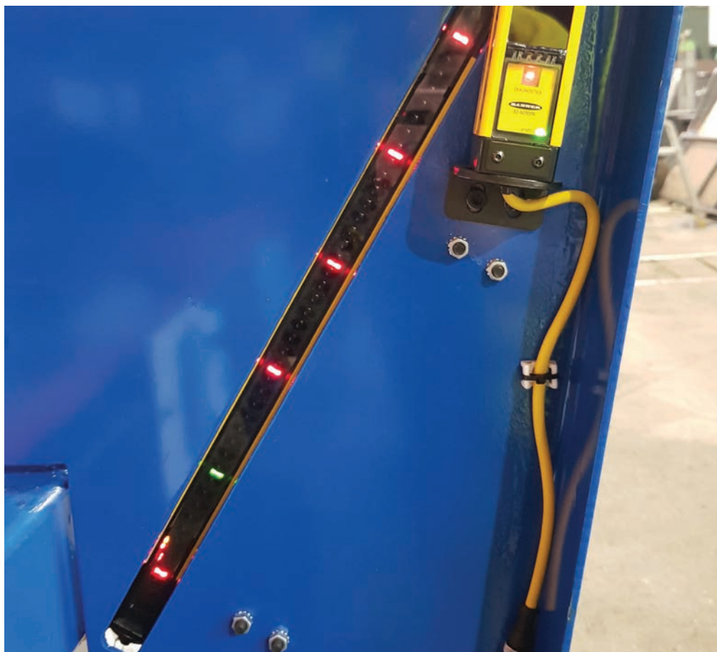
Kurtyny bezpieczeństwa marki Banner Engineering chronią operatora w trakcie pracy maszyny
