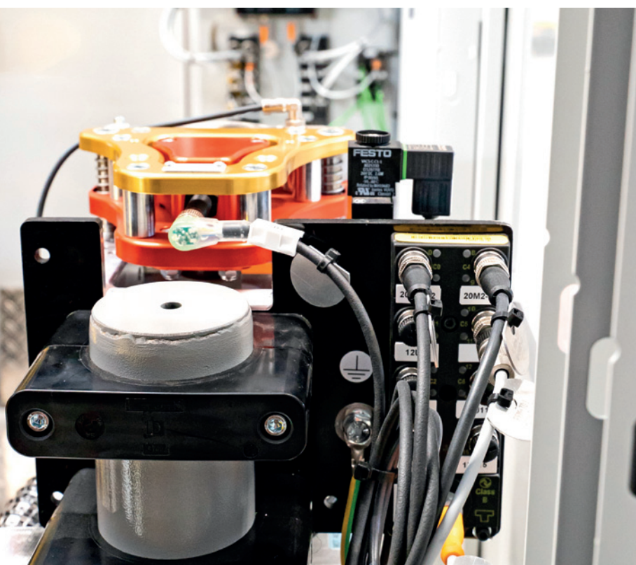
Koncentrator I/O TBIL przekazuje sygnały z noża spawalniczego do mastera IO-Link ( w tle)
