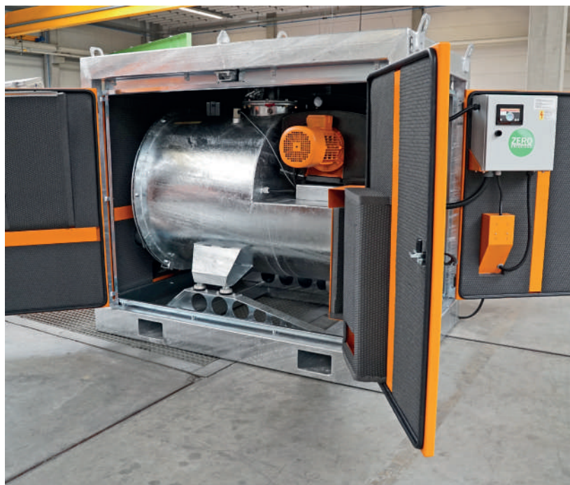
Woda z gruntu jest czasowo magazynowana w zbiorniku, a stamtąd pompowana do akwenu lub kanalizacji
