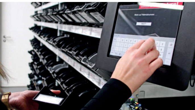
Opracowany we własnym zakresie kontroler KEB działa na tablecie z systemem Windows przymocowanym do półki
