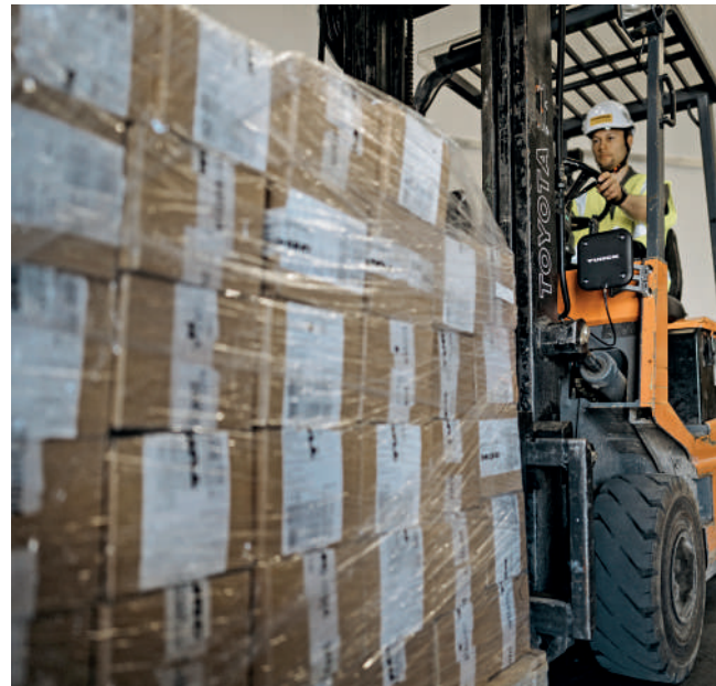
Wózki widłowe wyposażone w czytniki RFID umożliwiają niezawodną i szybką identyfikację palet i kontenerów
