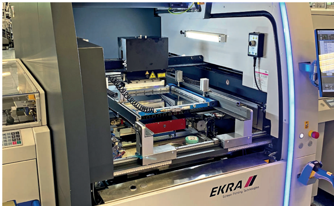
Pasty lutownicze umieszcza się w przedniej części drukarki, a czujnik CMTH bezpośrednio obok niej wykrywa warunki otoczenia
