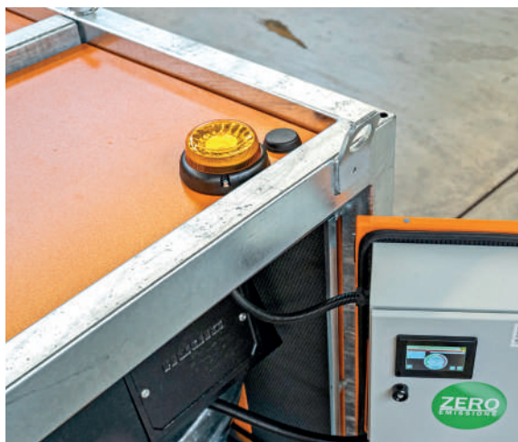
Antena i lampka sygnalizacyjna są zainstalowane na górze urządzenia
