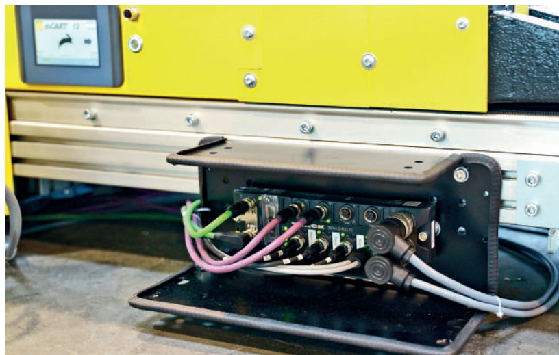
Sterownik Turck TBN-L-PLC kontroluje moduły systemu przenośników Krupsa. Komunikacja z oddalonymi urządzeniami odbywa się za pośrednictwem CAN i głównego sterownika poprzez Profinet lub Ethernet/IP
