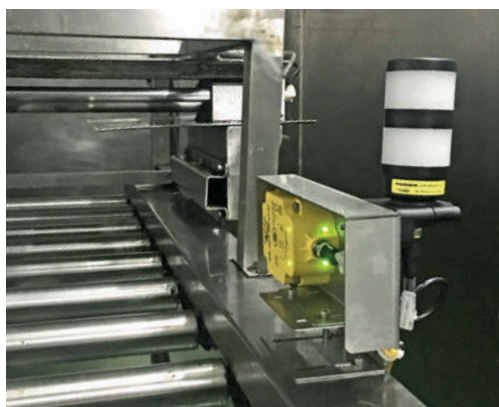
Urządzenia odczytu/zapisu RFID zostały zainstalowane we wszystkich strategicznych punktach procesu produkcyjnego
