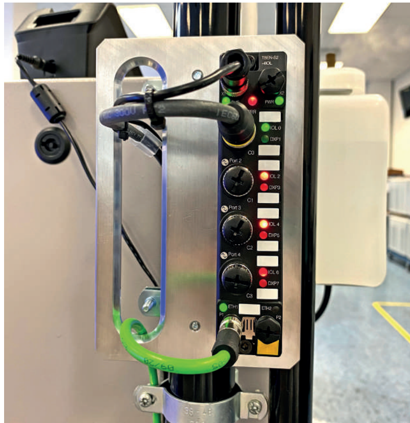
„Mózg” systemu: oparty na Linuksie IM18-CCM (CCM oznacza Cabinet Condition Monitoring) wypełnia lukę między OT a IT
