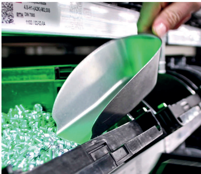
Wymagane części C są oświetlone i można je natychmiast zabrać, WLS15 są montowane za zagięciem płyty półki
