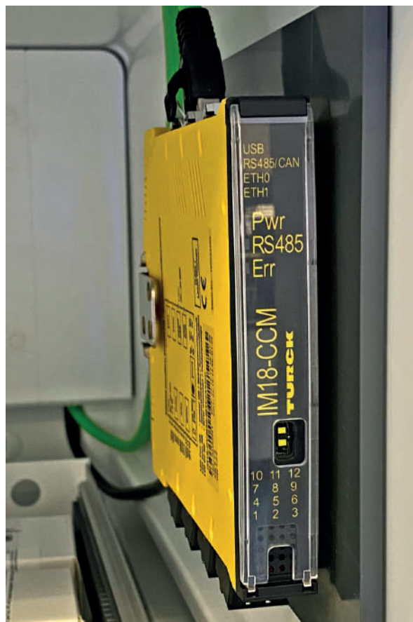
„Mózg” systemu: oparty na Linuksie IM18-CCM (CCM oznacza Cabinet Condition Monitoring) wypełnia lukę między OT a IT
