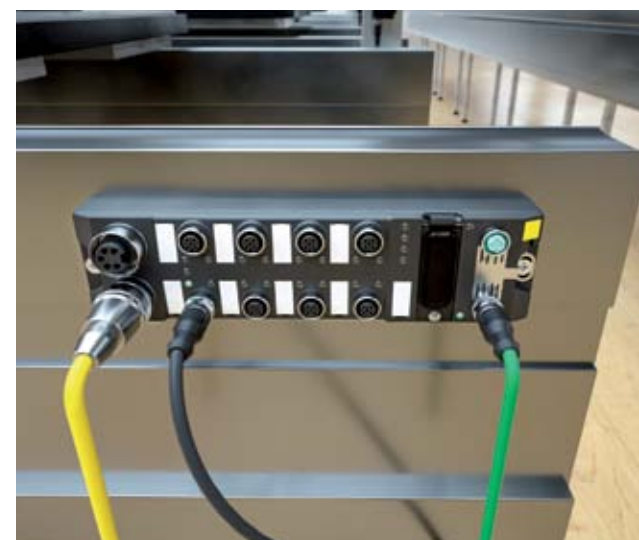
Do każdego kanału RFID można podłączyć 32 głowice odczytu/zapisu, a cztery kanały to 128 głowic odczytu/zapisu na moduł
