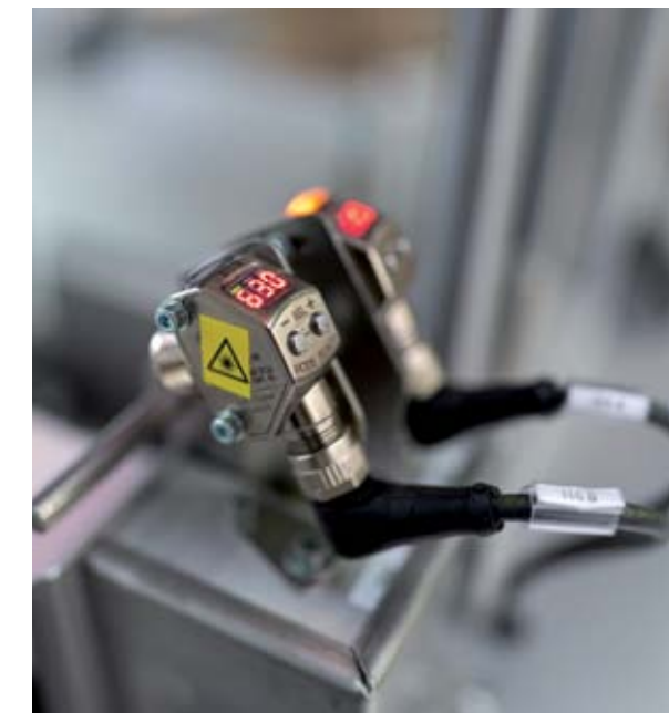
Lasery czujnik kontrastu Q3X, sprawdzający wyinięcie poduszki powietrznej
