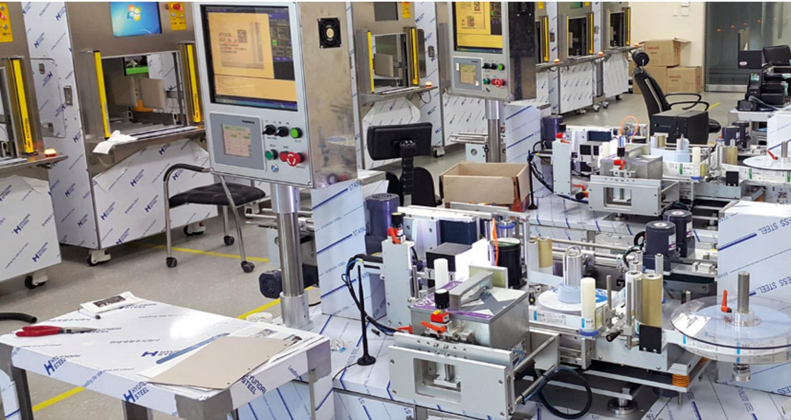
Das Pilotprojekt umfasste zunächst Entwicklung und Bau von insgesamt zehn RFID Bulk Reading Machines und sieben Etikettiermaschinen
