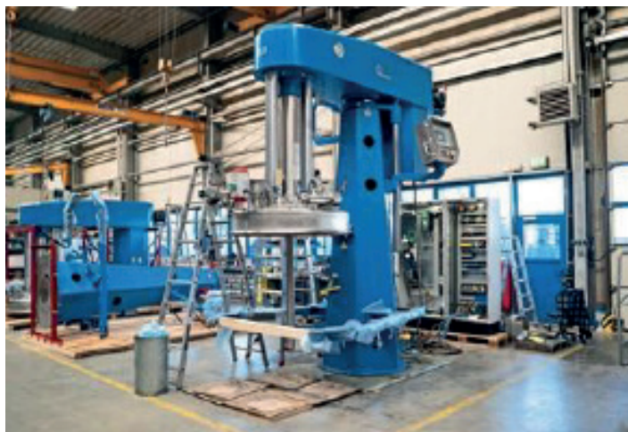
Niemann wyposaża swoje maszyny, takie jak disolwer Kreis w czujniki i separatory iskrobezpieczne firmy Turck
