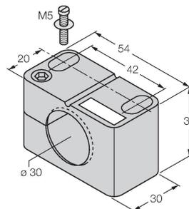
Монтажный зажим для цилиндрических резьбовых датчиков, с упором; материал: PA6
