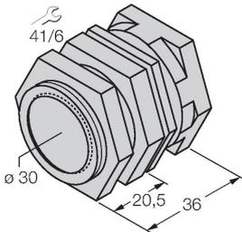
Зажим-фиксатор для быстрой установки; материал: Хромированная латунь. Наружная резьба M36 x 1,5. Примечание. При использовании кронштейнов для быстрого монтажа дистанция переключения датчиков приближения может меняться.
