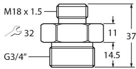
Ввинчиваемый адаптер для погружных датчиков серии FS.., FP..; материал: Нержавеющая сталь 1.4571 (316Ti); технологическое соединение: G3/4"
