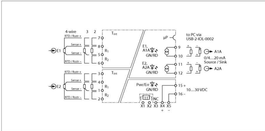
Le convertisseur de mesure de température IM12-TI01-2RTDR-2I-CPR/24VDC transmet les valeurs de mesure dépendantes de la température de manière séparée galvaniquement. Les appareils sont conçus pour un fonctionnement en zone 2.
