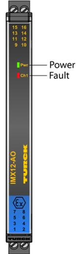
Le signal de courant normalisé est séparé galvaniquement par le séparateur de signaux monocanal IMX12-AO01-1I-1I-H0/24VDC de la zone non-Ex à la zone Ex. Sauf le signal analogique il est également possible de transmettre bidirectionnellement les signaux numériques de la communication HART®. Des applications typiques sont la commande de convertisseurs I/P ou d'appareils d'affichage dans la zone Ex.
