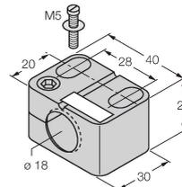
Bride de fixation pour détecteurs à tube fileté, avec butée fixe ; matériau : PA6
