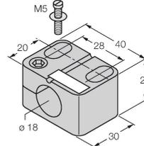
Bride de fixation pour détecteurs à tube fileté, sans butée fixe ; matériau : PA6
