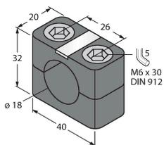
Bride de fixation pour détecteurs à tube fileté ; matériau : PA66-GF
