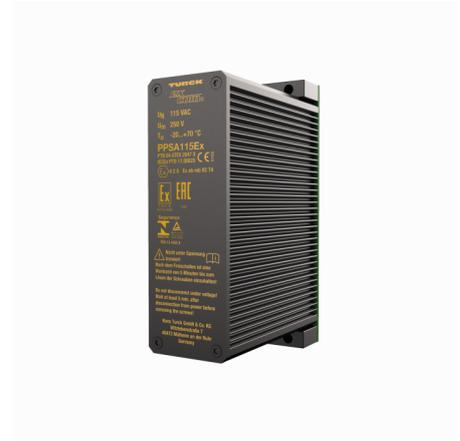
Le convertisseur AC/DC PPSA115Ex sert de l'alimentation du système excom® jusqu'à l'installation complète. Le convertisseur est conçu dans un mode de protection combiné Ex m et Ex e et permet donc d'être utilisé dans la zone 1. Il est entièrement surmoulé et logé dans un boîtier de protection en aluminium.
