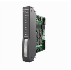
Le module d'entrée/sortie DM80-N sert de la connexion de détecteurs NAMUR (DIN EN 60 947-5-6) et d'actuateurs. Si la surveillance aux ruptures de câble ou aux courts-circuits est activée et que l'on utilise des contacts mécaniques, ces contacts doivent être équipés de résistances (WM1, n° d'identité).
