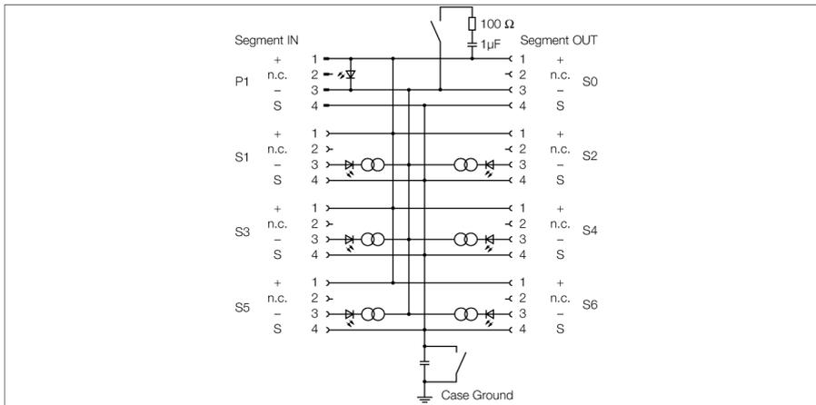
Le répartiteur Ex à six canaux du type JBBS-48SC-M613/EX est conçu pour le PROFIBUS-PA.
