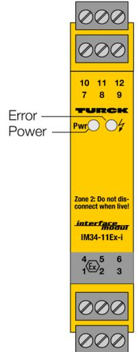
El amplificador de medición de temperatura Ex de 1 canal del tipo IM34-11EX-I procesa los cambios dependientes de la temperatura de resistencias Ni100/Pt100 y termoelementos de los tipos B, E, J, K, L, N, R, S y T, así como tensiones bajas en el rango de -100...+160 mV, emitiéndolos como señales de corriente de 0/4...20 mA lineares a la temperatura.
