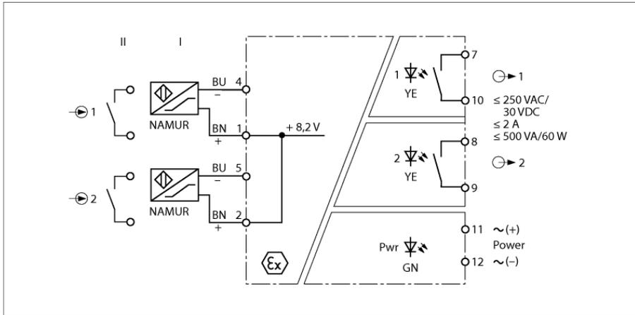
El amplificador separador de dos canales tipo IM12-22EX-R/230VCA está dotado de circuitos de entrada con seguridad intrínseca.
