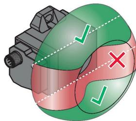
La ilustración de la izquierda muestra la orientación necesaria del cabezal de lectura y escritura con respecto al soporte de datos. En esta ilustración se representa a modo de ejemplo el cabezal de lectura y escritura TNSLR-Q42TWD-H1147 (para todos los cabezales de lectura y escritura apropiado). Debe tenerse en cuenta la orientación del soporte de datos (flecha).
