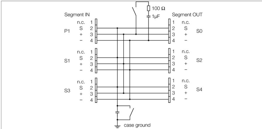
El módulo de distribución de cuatro canales, tipo JBBS-49-T415/3G, está diseñado para el bus de campo FOUNDATION™.
