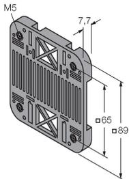
placa de montaje para rail DIN, apto para los modelos CP80, DX80, K80, Q80, temperatura de servicio: -20... 90 °C
