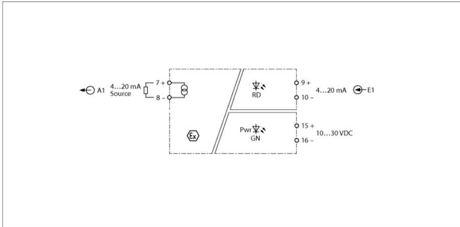
Über den 1-kanaligen Signaltrenner IMX12-AO01-1I-1I-H0/24VDC wird das normierte Stromsignal 1:1 galvanisch getrennt aus dem Nicht-Ex-Bereich in den Ex-Bereich übertragen. Neben dem Analogsignal können bidirektional auch digitale Signale der HART®-Kommunikation übertragen werden. Typische Anwendungen sind die Ansteuerung von I/P-Wandlern oder Anzeigegeräten im Ex-Bereich.
