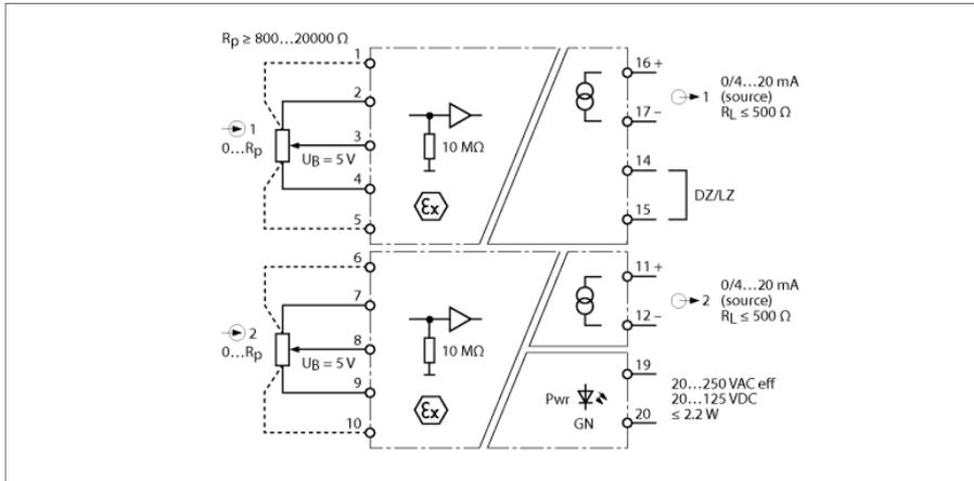
Über den 2-kanaligen Potenziometerverstärker IM36-22EX-I werden Signale von Potenziometern in 3/5-Leiter-Schaltung galvanisch getrennt aus dem Ex-Bereich in den Nicht-Ex-Bereich übertragen und in normierte Analogsignale von 0/4...20 mA umgewandelt. Der Live-zero-Betrieb für beide Kanäle gemeinsam wird durch Brücken der Klemmen 14 und 15 eingestellt. Der Widerstandswert des Schleiferabgriffes wird von 0 Ω bis zum Nennwiderstandswert (Endwert) des Potenziometers erfasst und linear verarbeitet.
