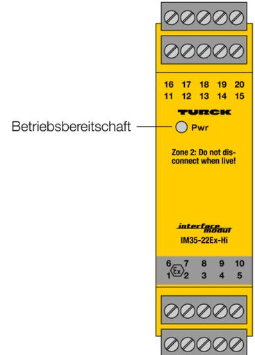
Über den 2-kanaligen Signaltrenner IM35-22EX-HI wird das normierte Stromsignal galvanisch getrennt aus dem Nicht-Ex-Bereich in den Ex-Bereich ohne Beeinflussung 1:1 übertragen. Neben dem Analogsignal können bidirektional auch die digitalen Signale der HART®-Kommunikation übertragen werden.
