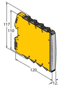
Ventil-Steuerbaustein; zweikanalig; SIL 2 gemäß IEC 61508; Ex-Ausführung; Überwachung auf Drahtbruch und Kurzschluss; abziehbare Schraubklemmen; 12,5 mm Breite; 24VDC Versorgungsspannung
