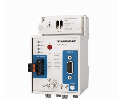
Der LWL-Medienkonverter FOC12... wandelt RS485-IS Signale, z. B. von PROFIBUS-DP oder Modbus RTU, von Kupferleitungen auf Lichtwellenleiter und vice versa um. Damit lassen sich eigensicher Bussignale aus der Zone 1 eigensicher, potenzialfrei und störungssicher über große Entfernungen übertragen.
