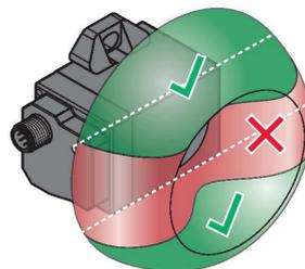
左侧的图显示了读写头必须向载码体对齐。
