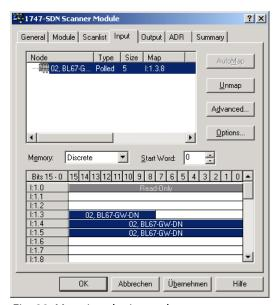
Fig. 32: Mapping the input data
