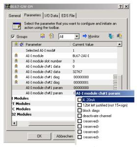
Fig. 36: Setting the parameters of a BL67 module
