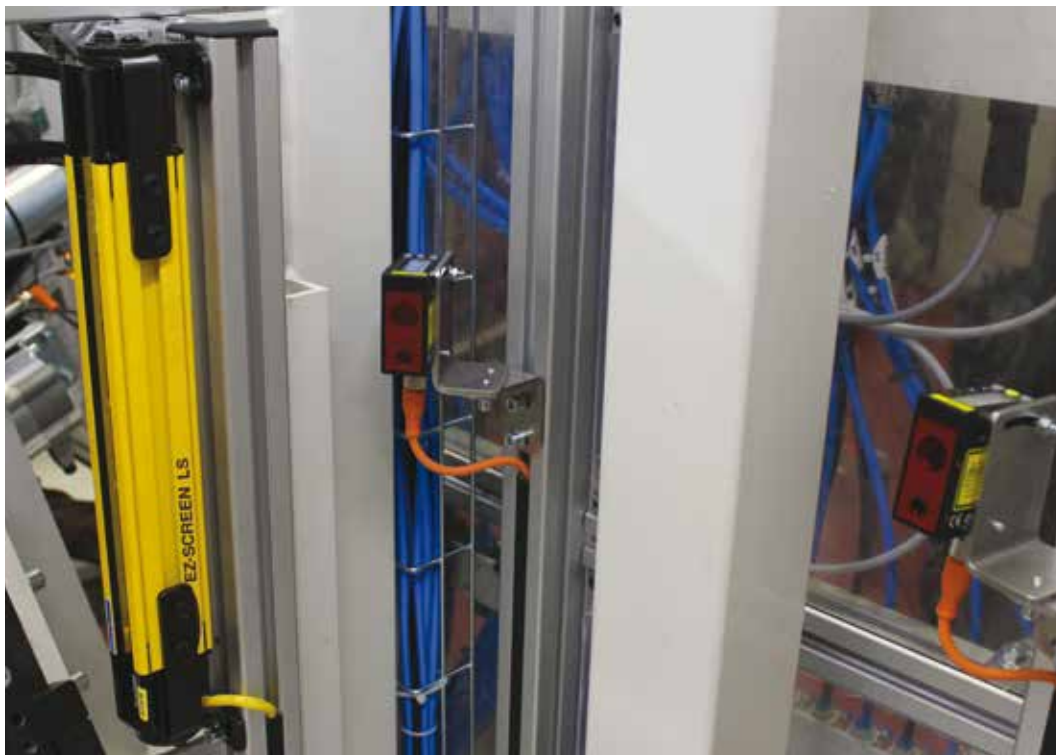
Kurtyna bezpieczeństwa EZ-SCREEN LS to kluczowy element systemu bezpieczeństwa. Widoczne obok dwa czujniki laserowe LE realizują zadania pomiaru odległości do montowanego obiektu
