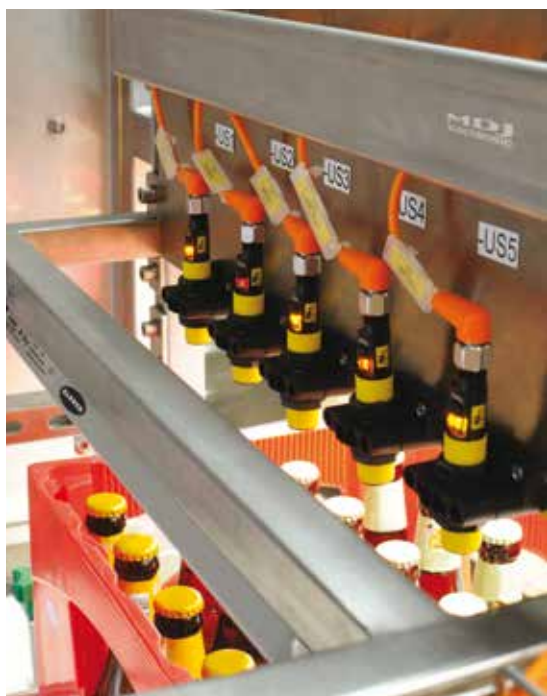
Czujniki ultradźwiękowe S18U (zdjęcie po lewej) wykrywają obecność kapsli, natomiast czujniki fotoelektryczne QS18 (zdjęcie po prawej) odpowiadają za pozycjonowanie skrzynek; oświetlenie linii zapewniają listwy LED serii WLS28
