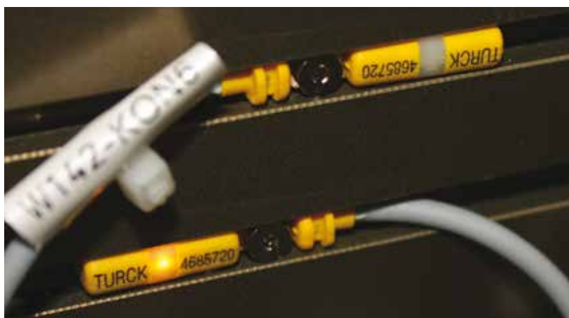
Magneto-indukcyjne BIM-UNT marki Turck to jedno z wielu czujników zastosowanych w stacji montażowej firmy Soning
