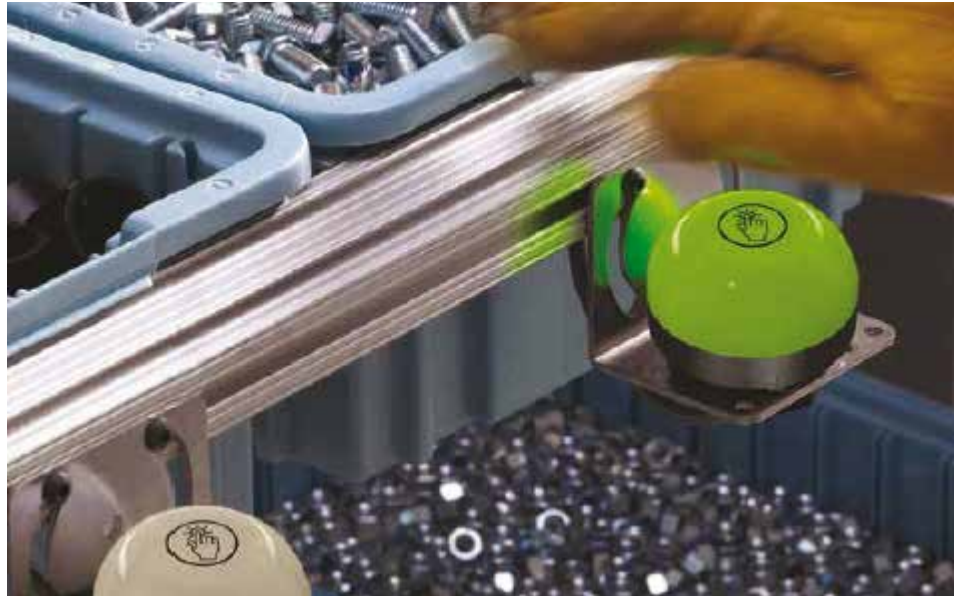
Przyciski bezprzewodowe K70 to jeden z podstawowych elementów systemu call-for-parts
