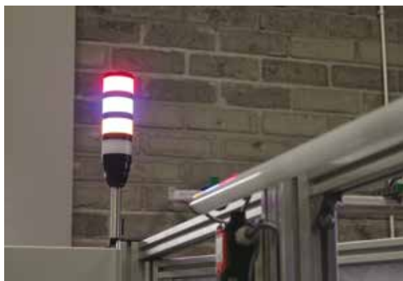
Kolumna świetlna TL50 zapewnia doskonale widoczną sygnalizację stanu maszyny
